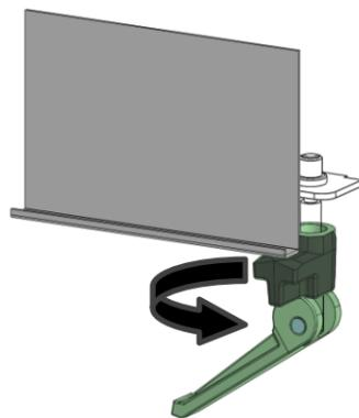
1 Nach dem Einsatz des Luftfilters schwenken Sie die Klammer auf.
