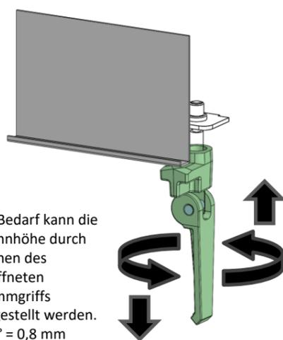
Bei Bedarf kann die Spannhöhe durch Drehen des geöffneten Klemmgriffs eingestellt werden.  $360^\circ = 0,8 \text{ mm}$
