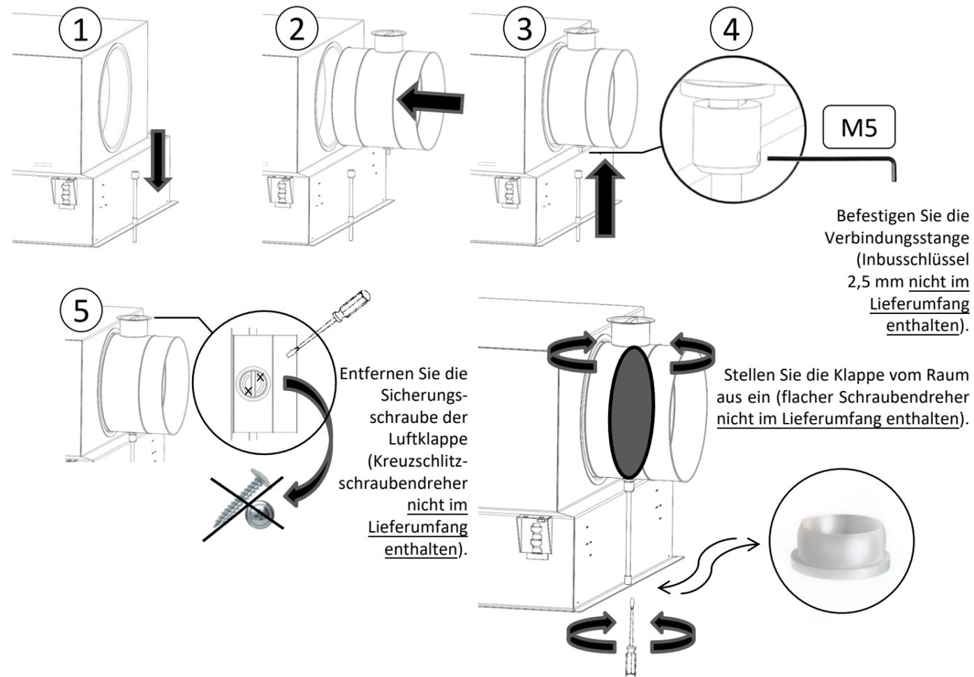
Befestigen Sie die Verbindungsstange (Inbusschlüssel 2,5 mm nicht im Lieferumfang enthalten).
